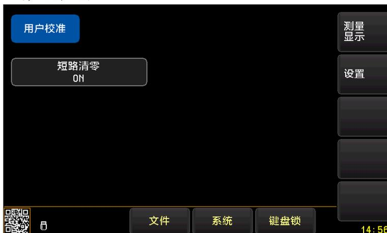
测试前，请务必执行一次短路清零，以去除由于测试线和外界环境因素造成的杂散电阻和偏压。为了达到仪器规定技术指标，必须执行短路清零。
