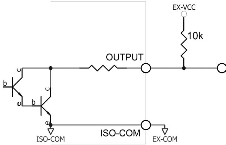
图 10-11 双端口输出组成逻辑或电路
