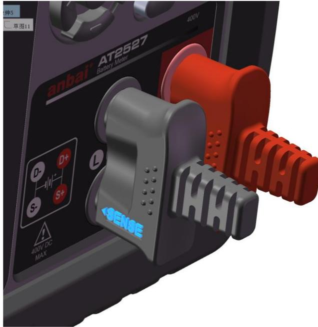
请按照上图连接测试线，注意 SENSE 在下方。
