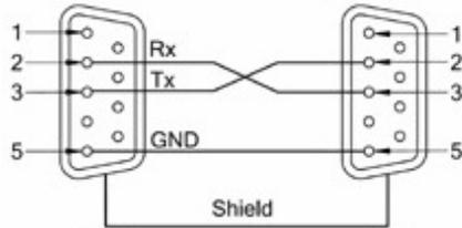
RS-232 串行接口可以和控制器（例如：个人电脑或工控机）的串行接口通过 2-3 交叉的 DB-9 电缆进行互连。通讯协议
