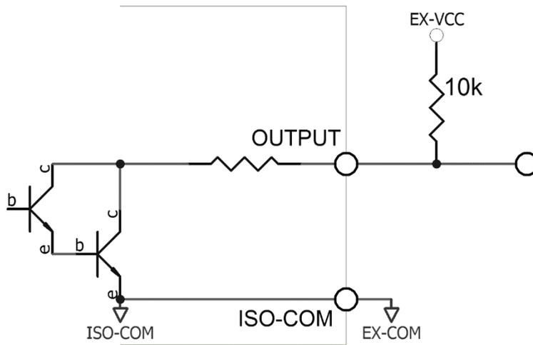
图 8-11 双端口输出组成逻辑或电路
