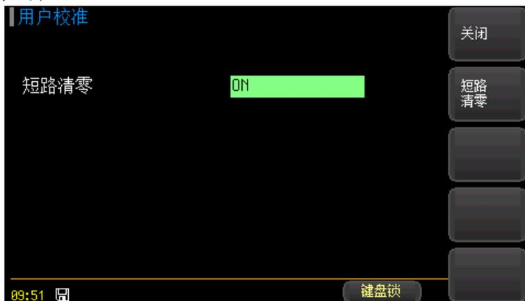
测试前，请务必执行一次短路清零，以去除由于测试线和外界环境因素造成的杂散电阻和偏压。为了达到仪器规定技术指标，必须执行短路清零。
