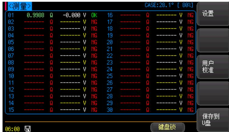
使用的 30 通道电阻、电压数据和比较结果将同时显示在屏幕上。
