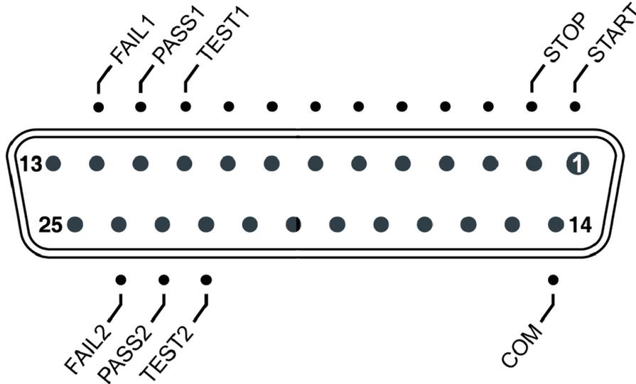
若要使用 HANDLER 功能,必须将仪器系统配置中的“控制模式”设为 PLC,否则 HANLER 功能不可使用;当控制模式”设为 PLC,前面板的“启动”按键将不可使用,以避免重复启动造成危险。
