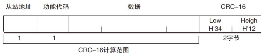
图 11-2 Modbus 附加 CRC-16 值
