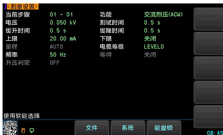
图 4-2 交流耐压测试参数设置页
