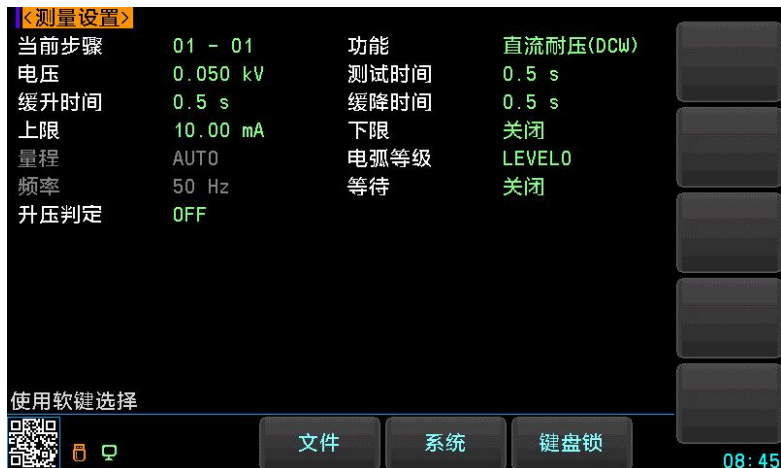
图 4-3 直流耐压测试参数设置页
