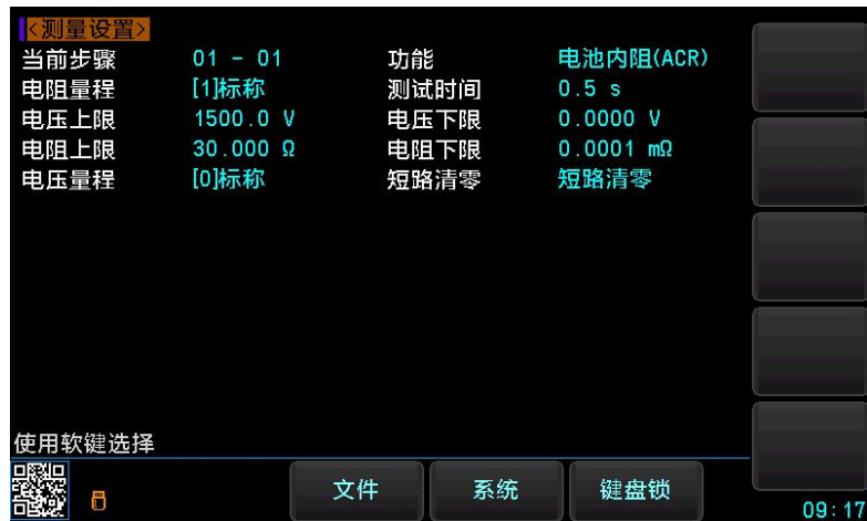
图 4-5 电池内阻测试参数设置页
