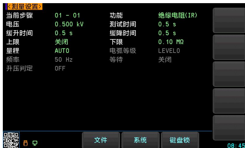
图 4-4 绝缘电阻测试参数设置页
