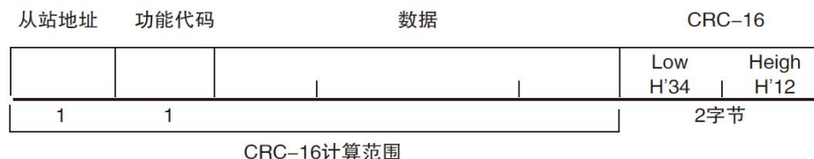
图 9-1 Modbus 附加 CRC-16 值
