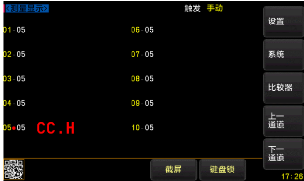
图 5-3 HIGH (+) 端测试线接触不良
